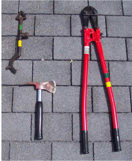
Hydrantenschlüssel, Feuerwehrbeil, Bolzenschneider
