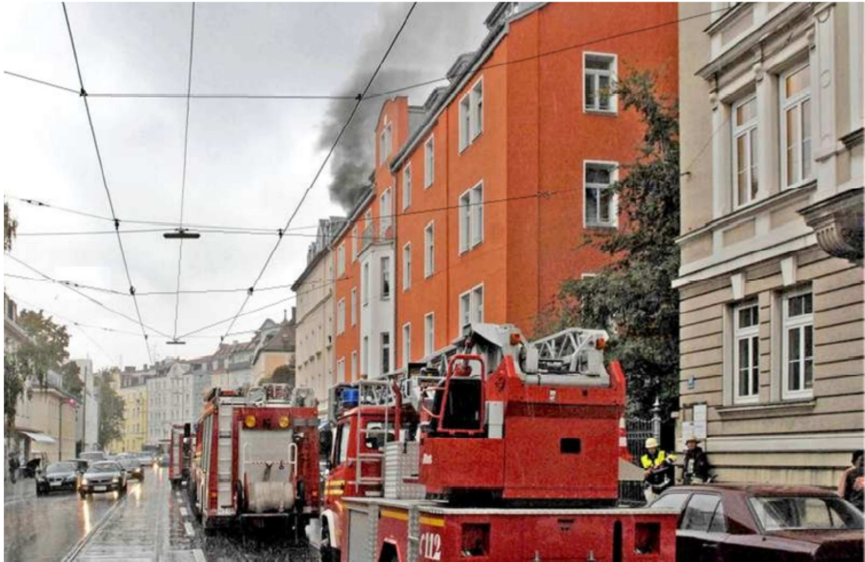
Oberleitungen - Die Anleiterung wird durch den Fahrdraht erheblich behindert und ist durch die seitlichen Abspannungen nicht möglich.
