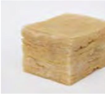
**Material** Dolomit, Altglas, Sand, Eisenoxid und Zement
