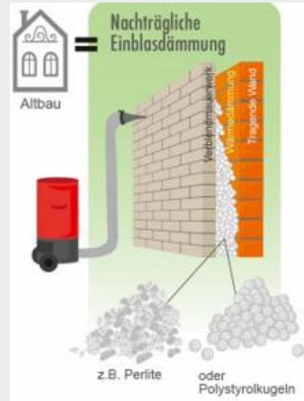
Abbildung 2 Methoden der Kerndämmung,
