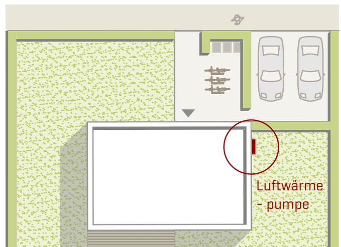
Abb. 124: Luftwärmepumpe - seitliche Aufstellung
