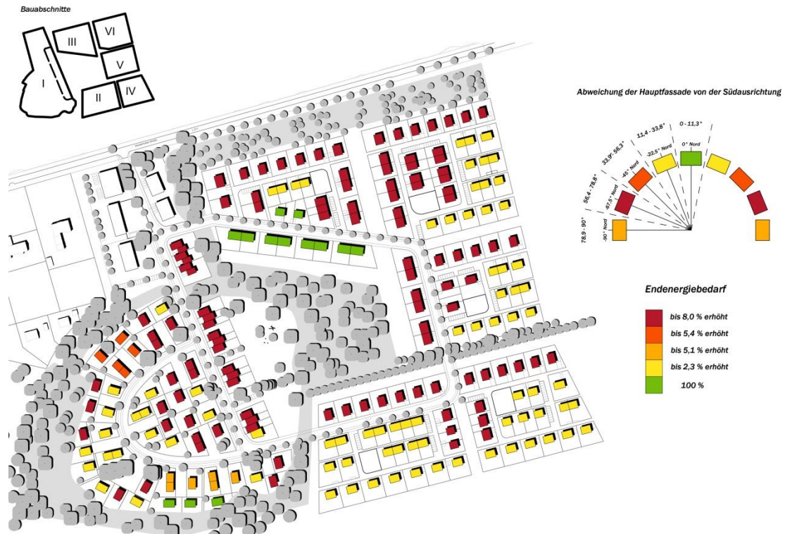
Abbildung 5: Gebäudestellung und Endenergiebedarf
