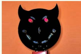
Durch Durch eine einfache Schaltung aus wenigen elektronischen Bauteilen basteln wir gemeinsam eine Teufelsmaske mit blitzenden Augen. Zunächst machst Du ein paar Lötübungen aus Draht, um die Technik des Lötens zu erlernen. Im zweiten Schritt erklären wir Dir den Schaltplan, damit Du weißt, warum die Augen mit
