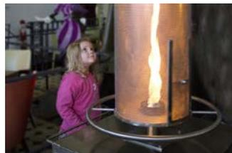
Was Sauerstoff so alles kann: Aus einer kleinen Flamme wird durch eine kleine Drehung ruckzuck ein beeindruckender Feuertornado. In einem drehbaren Zylinder aus Drahtgewebe befindet sich eine kleine Flamme. Versetzt man den Zylinder in Rotation, entsteht eine beeindruckende Feuersäule. Besucht unsere wahrscheinlich „heißeste“ Experimentierstation und erlebt Phänomene wie den „Pirouetten-Effekt“ live! Da staunen übrigens nicht nur die Kleinen.
