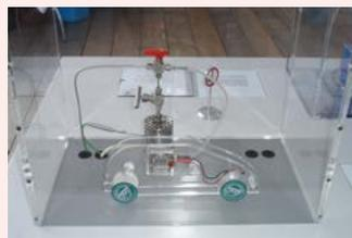
Wie werden die Autos der Zukunft betrieben? Welche Möglichkeiten existieren bereits, umweltfreundlich zu handeln? In der Experimentierwerkstatt zeigt Euch das Max-Planck-Institut für Kohlenforschung, wie der Antrieb eines Fahrzeugs über eine Brennstoffzelle funktioniert. Bei uns wird deutlich, wie sauber Energie sein kann: Die Abgase bestehen nur aus Wasserstoff, der sich mit dem Sauerstoff der Luft zu Wasser verbindet. Bei uns lernt man das Fahren der Zukunft hautnah kennen!
