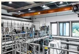
Flammen-, Plasma- und Heißwandreaktoren – über drei Etagen verteilt sich das „Herzstück“ des NETZ. Wir zeigen Euch, wie in den hauseigenen Anlagen aus verschiedenen Gasen hochreine Nanopartikel mit maßgeschneiderten Eigenschaften hergestellt werden – wie etwa für Batterien oder Thermogeneratoren.
