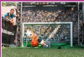
Fordern Sie den RoboKeeper heraus. Aber Vorsicht, der Fußballroboter reagiert wahnsinnig schnell! Im Bruchteil einer Sekunde verfolgen Kameras in seinen Augen die Flugbahn des Balls. Eine Bildverarbeitungssoftware errechnet den Einschlagpunkt und die Motorsteuerung setzt die Bewegung des Roboters in Gang. Schaffen Sie es trotzdem, ein Tor zu erzielen? Probieren Sie es aus und erfahren Sie, welche Technik hinter dem Fußballstar von morgen steckt.
