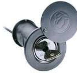
Zur Installation eines Feuerwehrschlüsseldepots Typ „A“ gehört auch der Einbau eines Freischaltelements (FSE), mit dem das FSD auch bei Nichtauslösung der Brandmeldeanlage durch die Feuerwehr aktiviert und geöffnet werden kann.
