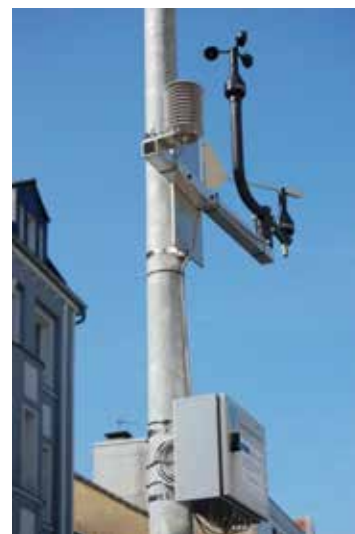
Abb. 2: Aufbau einer Klimafeststation
